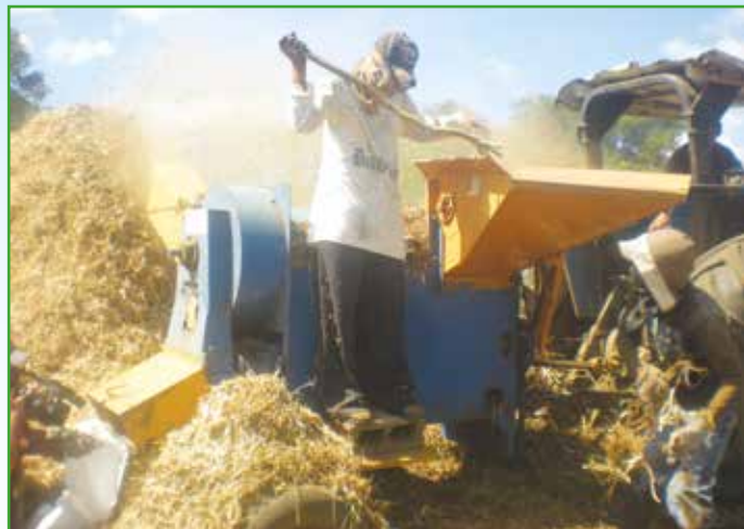
Foto: Máquina trilladora de frijol.
