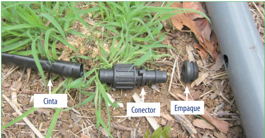
Figura 14: Orden en que se ubica la tubería con respecto al empaque, conector y cinta.
