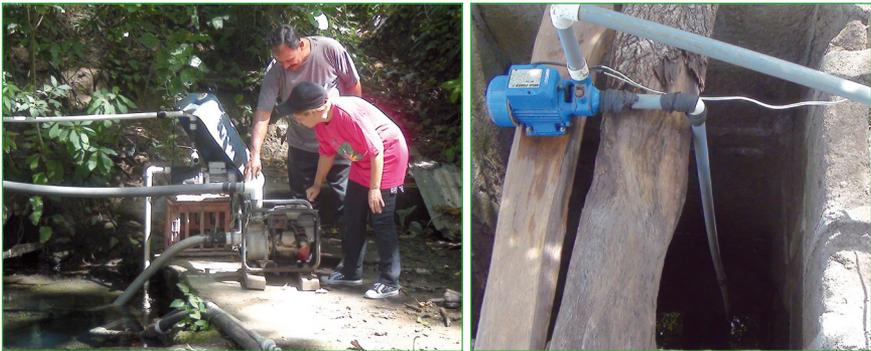
Figura 3: Muestra del sistema de bombeo usualmente utilizado en los departamentos de Managua y Chontales.
